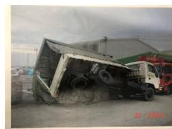
カーブなどを曲がる時に車両には遠心力がかかります。この遠心力は重量に比例して大きくもなります。よって、過積載をしている場合、重量が重くなる分だけこの遠心力が大きく左右します。また、過積載の場合は一般的に重心が高くなります。重心が低い場合より高い場合のほうが重心位置のズレが大きく不安定になるため、横転事故を起こす危険が高まります。
